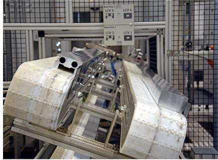
**3** Teiletransfer für die Roboterzellen: links das Zuführband mit Säge-Profilabschnitten, rechts das Abführband mit Fertigteilen © Hanser
